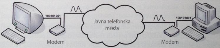
Slika 2. Načelni prikaz prijenosa digitalnih podataka modemom
