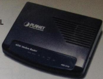
Slika 5. ADSL uređaj ("modem")
